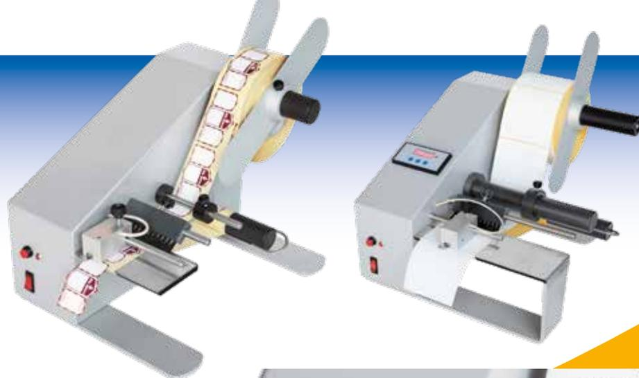
Opzionale per tutti i modelli è un contatore elettronico a preselezione con conteggio progressivo delle etichette erogate o regressivo con l'arresto dell'erogazione di etichette una volta raggiunto il numero impostato.
