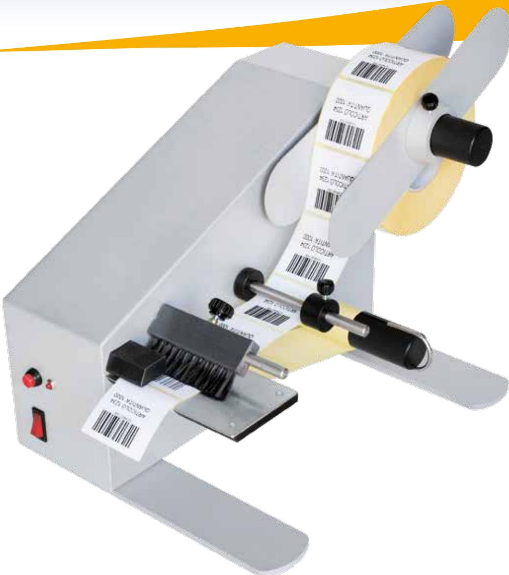
Il portabobina, adattabile a qualsiasi anima interna, accetta bobine fino a 300 mm. di diametro e permette quindi una grande autonomia di lavoro.
