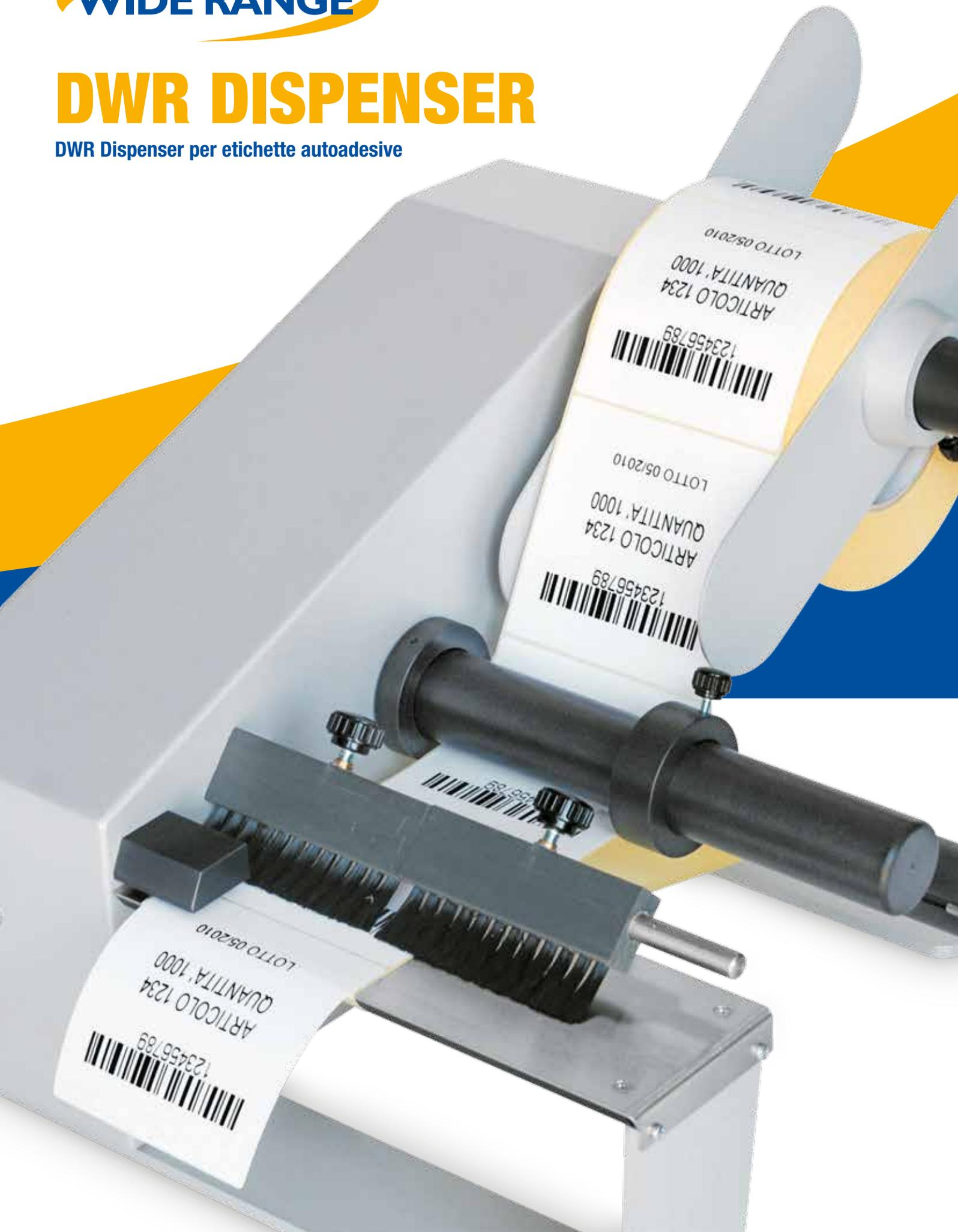
**DWR 100 e DWR 200 sono una serie di distributori semiautomatici di etichette autoadesive in rotolo. Concepiti per ambienti industriali, sono completamente costruiti in acciaio, semplici da utilizzare e versatili per ogni tipo di etichetta normalmente in uso. Disponibili nelle versioni con larghezza etichetta fino a 100 mm. o 200 mm.**
